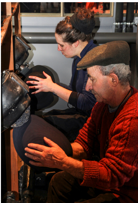
MARION CLÉMENT, CHAPÉLIÈRE-MODISTE DE L'ATELIER-MUSÉE DU CHAPEAU, EN FORMATION AU PONÇAGE DES CLOCHES, AVEC M. RENÉ PEYSSELON, CHAPÉLIER CASTORINEUR.
